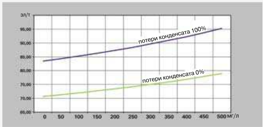
Изменение стоимости пара, произведенного паровым котлом мощностью 4000 кВт 10 бар в зависимости от концентрации солей в питательной воде
