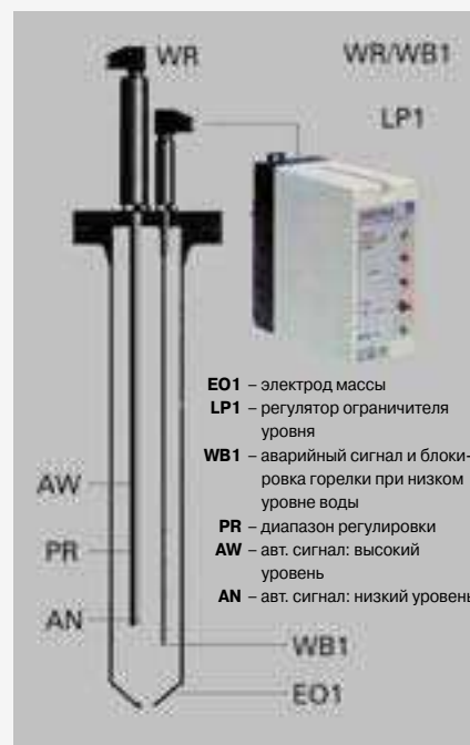
Объемный электрод с ограничителем уровня воды
